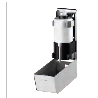
Gehäuse nach vorne geöffnet, Befüllung direkt im Spender möglich oder durch Herausnehmen des 0,8 Liter Nachfüllbehälters.
