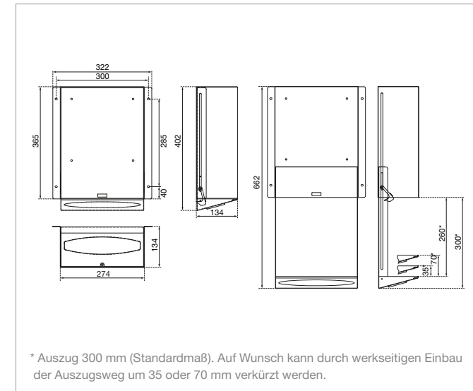
Art. 20-167: Technische Zeichnung für herausziehbaren Hinter-Spiegel-Papierhandtuchspender. Auf genügend Abstand zum Waschtisch achten, Auszugsweg 300 mm.
