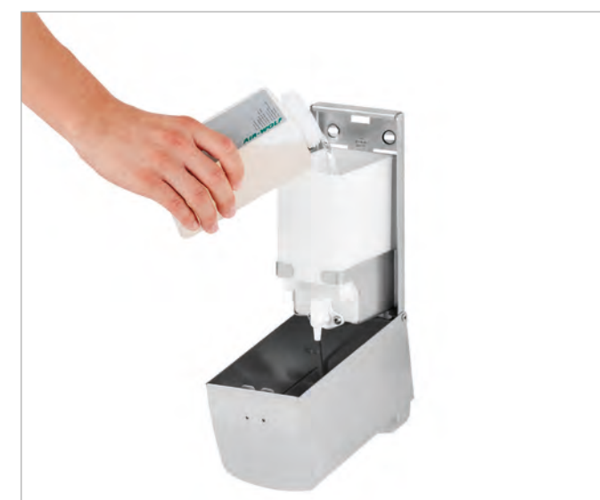
Richtig: Der Behälter ist zur Befüllung und Reinigung entnehmbar, Pumpe am tiefsten Punkt zur vollständigen Entleerung der Seife.
